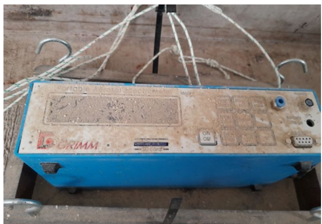
↑ Staubmessgerät nach den Messungen
