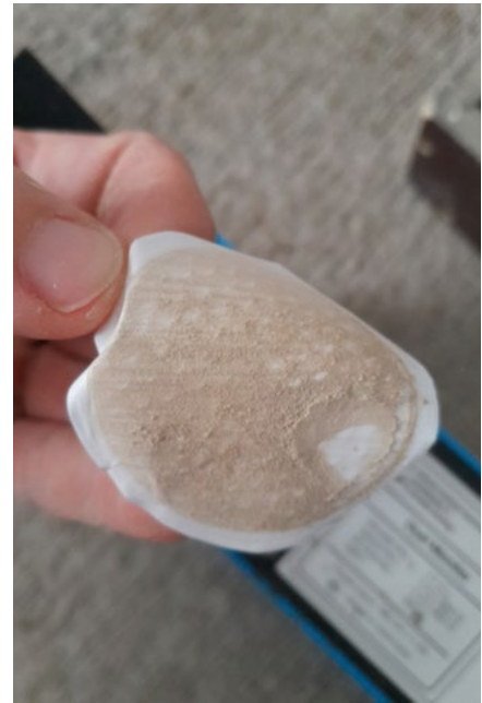
↑ Staub am Filter des Messgeräts
