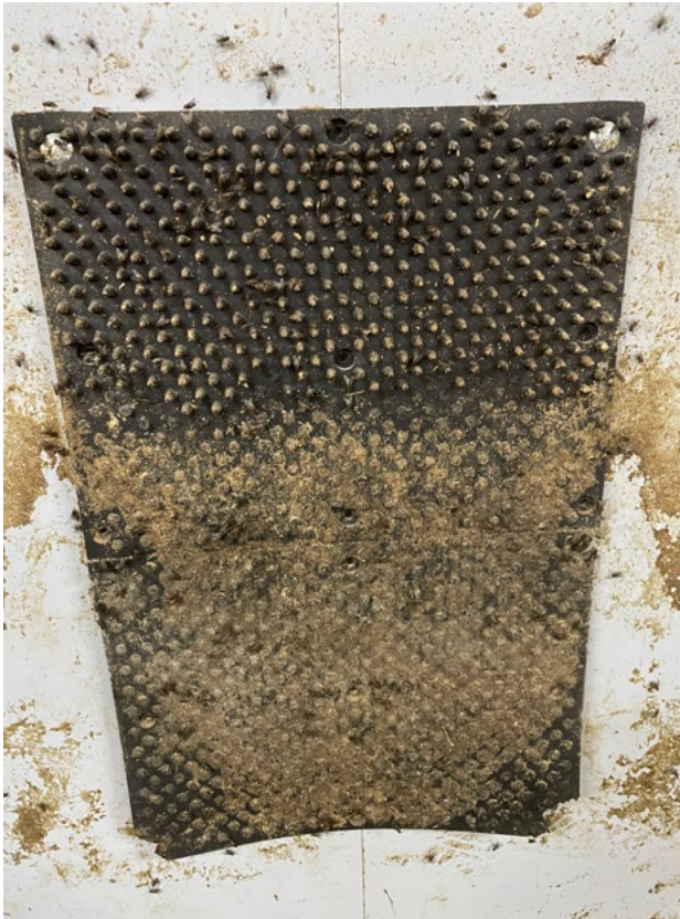
↑ Abbildung 7: Kratzmatte aus Gummi: an der unteren Hälfte abgenagte Noppen und aus der Wand gerissene Verankerung
